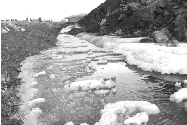
Salzgärten im Randgraben der Halde Ronnenberg. Bei niedrigen Temperaturen kristallisieren Sulfatsalze aus den gesättigten Haldenlösungen aus. Diese Haldenwässer werden in die Fließgewässer eingeleitet.
